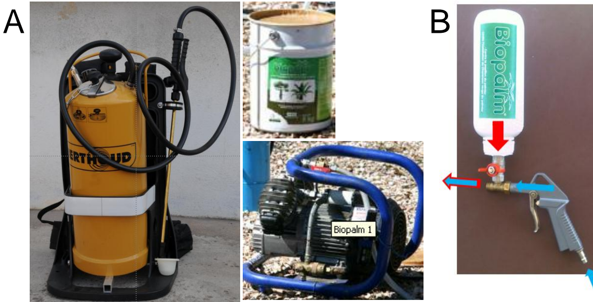
Figure 4: (A) Appareillage pour projeter la glu pour les professionnels avec pulvérisateur et compresseur et (B) pour les particuliers avec pistolet + cartouche de Biopalm et compresseur. (Photos LOF / C. Vastel)
